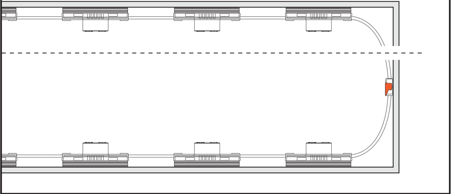
Bitte verbinden Sie die Module mit Hilfe von Schnellverbinder, die der IP67 Schutzart entsprechen.
