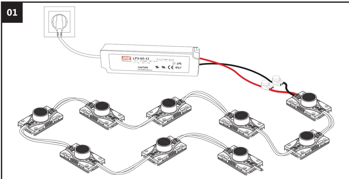
Vor der Montage ist die Korrektheit des Leuchtens und die bestellte Farbe von dem ganzen Buendel zu pruefen.
