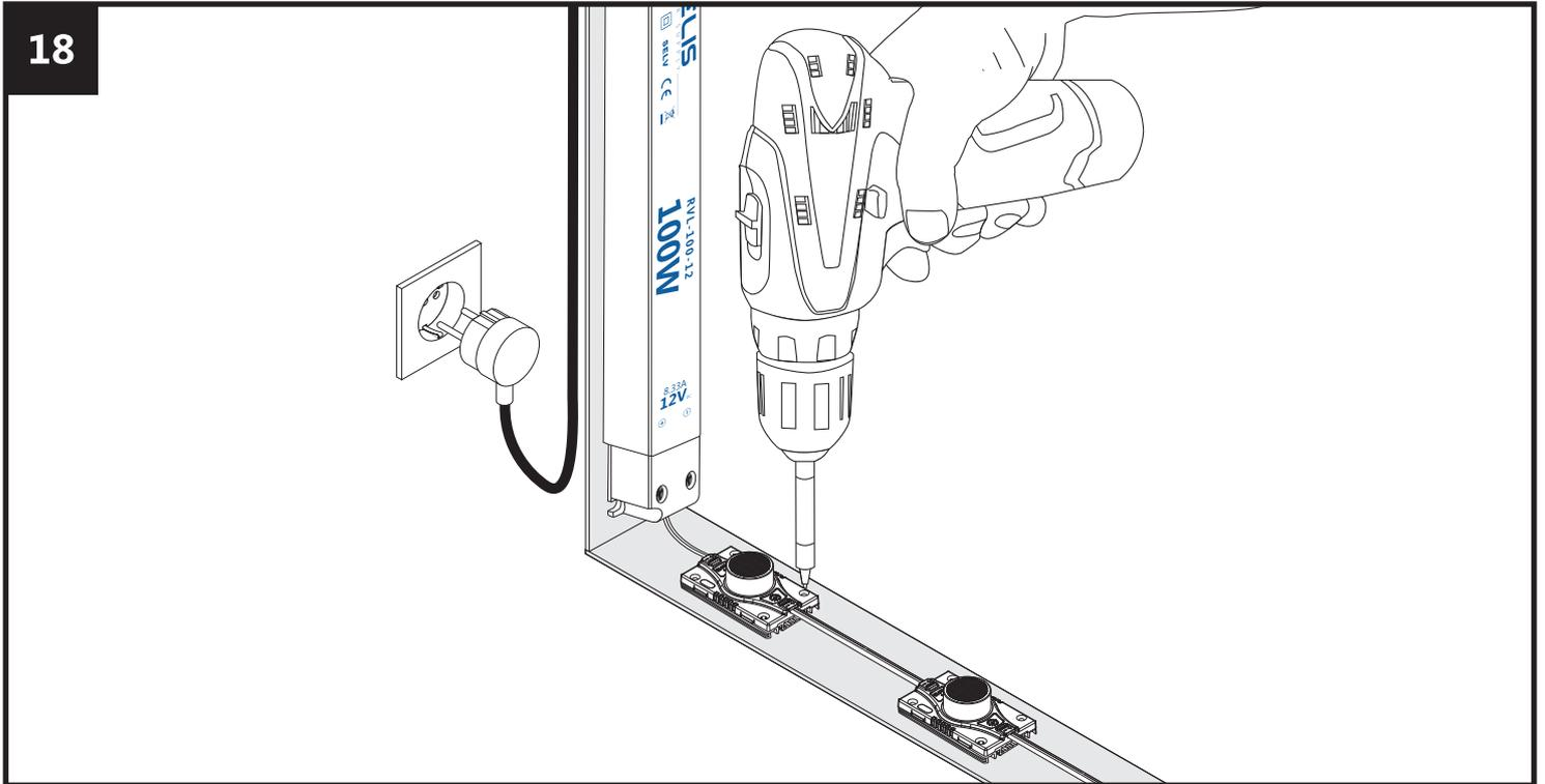
Die Module auf der Flaeche montieren – schrauben, vernieten oder zusaetzlichen Klebstoff verwenden.
